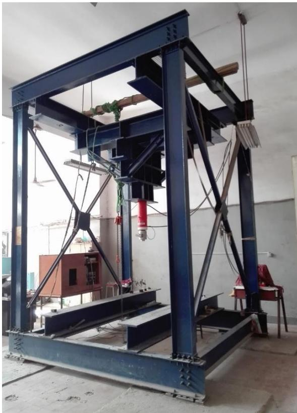
**Fig. 6. Rigid steel frame**
